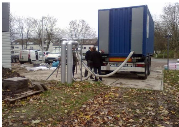
Abbildung 29: Latentwärmespeicher der Firma LaTherm (links: Entladeplatz an der Wärmesenke; rechts: Beladestation an der Abwärmequelle; Quelle: bifa Archiv)
