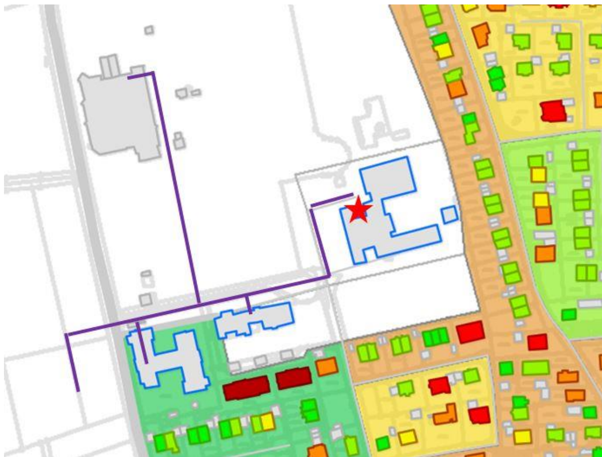
Abbildung 53: Erste Ausbaustufe des Wärmenetzes an der Grundschule (roter Stern: Standort der Heizzentrale)
